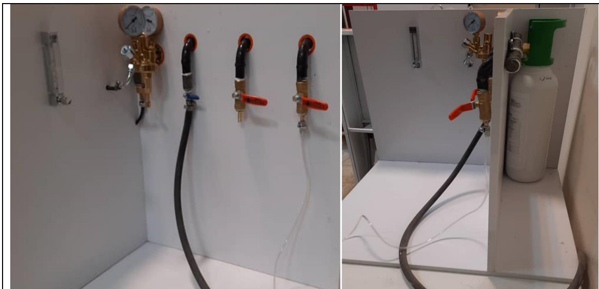
شکل (۵) بستر تست طراحی و ساخته شده، جهت داده برداری نقطه به نقطه عملکرد دستگاه
