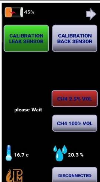
شکل (۴) ورودی لوله های کالیبره و بخش کالیبره نرم افزار رابط کاربری دستگاه
