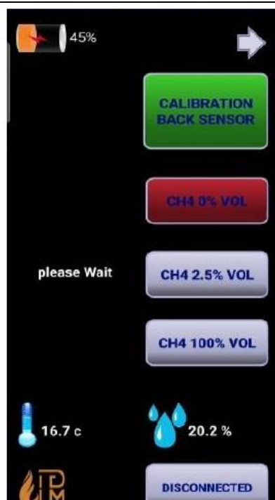
شکل (۴) ورودی لوله های کالیبره و بخش کالیبره نرم افزار رابط کاربری دستگاه
