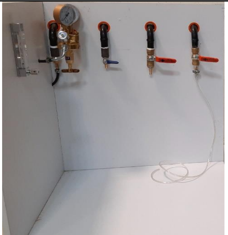
شکل (۳) - بستر کالیبراسیون دستگاه پرتابل تشخیص و اندازه گیری دبی گاز طبیعی
