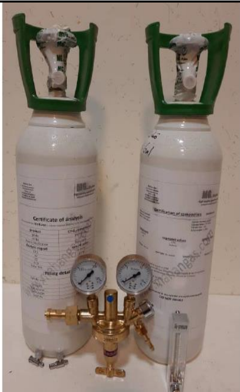
شکل (۳) - بستر کالیبراسیون دستگاه پرتابل تشخیص و اندازه گیری دبی گاز طبیعی
